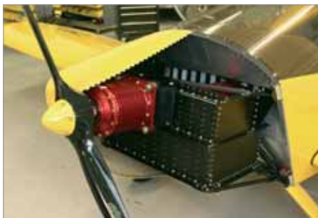
Sonex: Das ganze Antriebssystem mit Motor und „Tank“.
