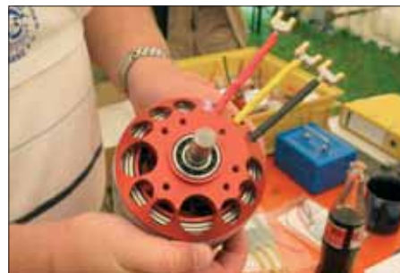
Lemak / RS-LRK-Motor: 16 PS bei nur 3 Kilogramm.
