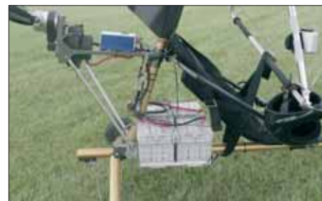
Fishman's Lithium-Polymer-Batterie mit 3,5 kWh.
